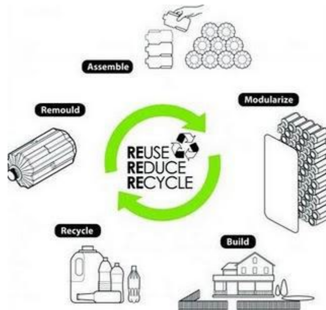
Gambar 5. Pola kerja pemanfaatan botol plastik daur ulang
